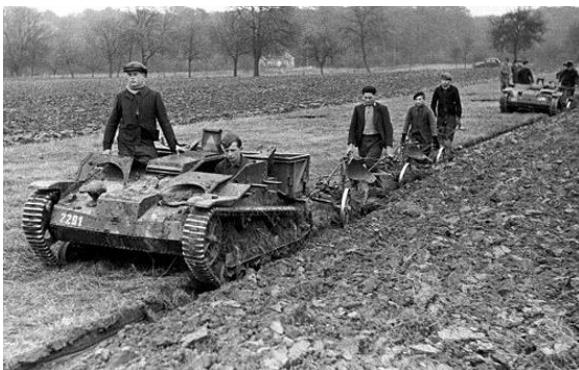
Deutsche Soldaten helfen französischen Bauern beim Pflügen ihrer Felder mit gepanzerten Renault UE Chenillette. Das ist ein kleiner Transportpanzer und Artillerieschlepper, der in den frühen 1930er-Jahren von der französischen Firma Renault produziert wurde. Seine Hauptaufgabe war der Transport von Munition und das Ziehen von Mörsern und leichten Geschützen. Die Wehrmacht setzte ihn in der gleichen Funktion und für verschiedene andere Aufgaben ein, darunter auch diese. Frankreich, 1941. Bei der deutschen Wehrmacht trug der Wagen später die Bezeichnung Infanterieschlepper UE 630 (f).
